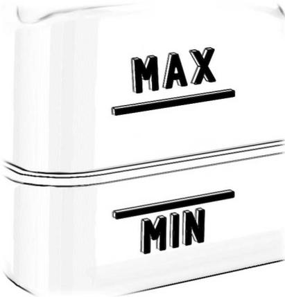
Wenn der Füllstand des Servolenkungsöls unter der Markierung **MAX** liegt, füllen Sie Servolenkungsöl mit der richtigen Spezifikation nach. Siehe **Füllmengen und Spezifikationen** (Seite 390). Siehe **Füllmengen und Spezifikationen** (Seite 396).
