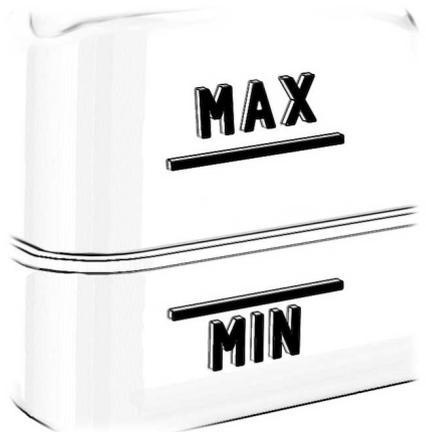
Vergewissern Sie sich, dass sich der Füllstand bei Umgebungslufttemperatur sowohl im Kühlmittelbehälter für den Motor als auch in dem für den Elektromotor zwischen den Markierungen **MIN** und **MAX** befindet. Wenn sich der Kühlmittelstand an oder unter der Mindestmarkierung befindet, sofort Kühlmittel nachfüllen.
