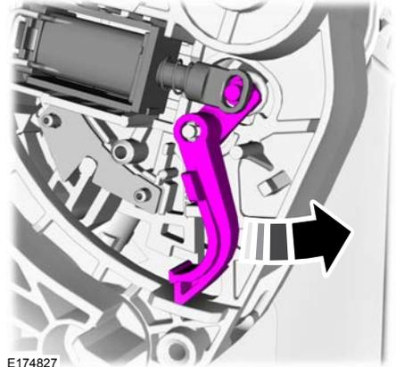
3. Den Hebel – Wählhebelsperre in Richtung Fahrzeugheck schieben und dort halten.
