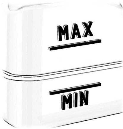
Vergewissern Sie sich, dass sich der Füllstand bei Umgebungslufttemperatur des Kühlmittels zwischen den Markierungen **MIN** und **MAX** des Kühlmittelbehälters befindet. Wenn sich der Kühlmittelstand an oder unter der Mindestmarkierung befindet, sofort Kühlmittel nachfüllen.
