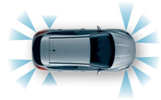
**Ultraschall-Parkensensoren** zur Steuerung des Park-Assistenten sind in die Stoßfänger vorne und hinten eingebaut.
