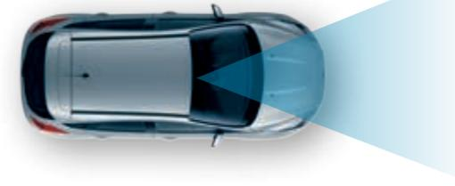
**Infrarot-Laser-Sensoren** (LIDAR) für die Active City Stop-Technologie befinden sich im Gehäuse der Frontkamera.
