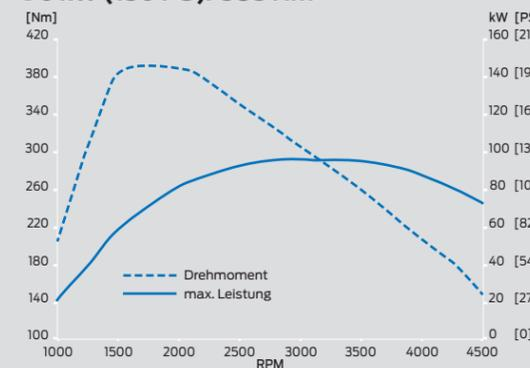
**2,0-l-TDCi Ford EcoBlue Motor mit 125 kW (170 PS)/405 Nm**
