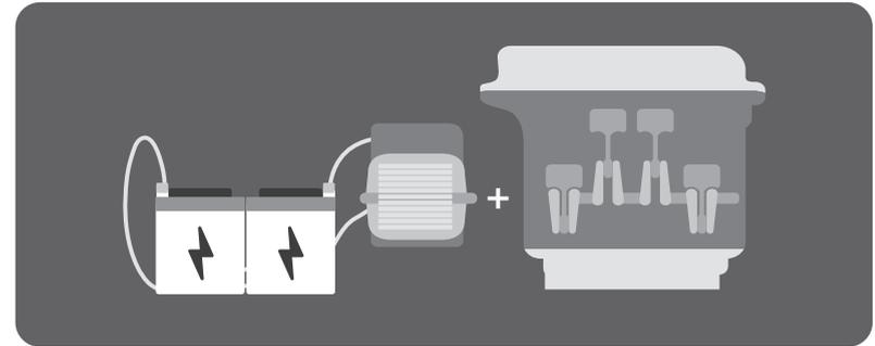
Angetrieben wird der Elektromotor von einer Lithium-Ionen-Batterie. Die flüssigkeitsgekühlte/-beheizte Batterie reduziert Energieverlust und Wärmeentwicklung des Elektromotors und sorgt so für verbesserte Langlebigkeit und Effizienz.
